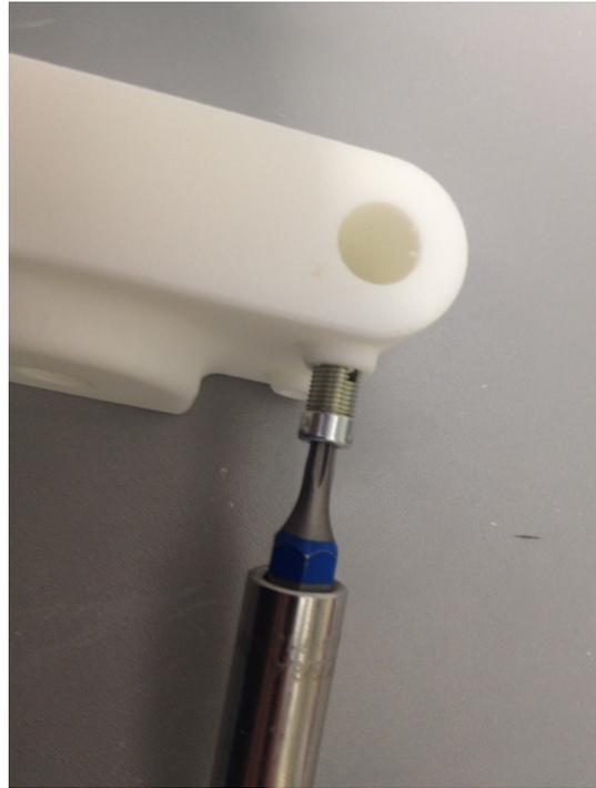
*Abbildung 10: Gewindeeinsatz einsetzen*
