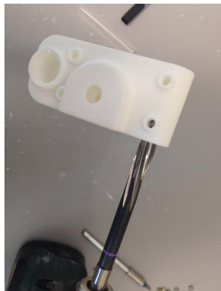
*Abbildung 8: Aufreiben der Bohrung mithilfe einer Reibahle*
